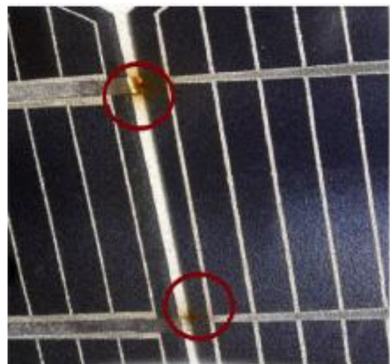
شکل (۱۱): خوردگی پنل‌های خورشیدی در نوار اتصال سلول
