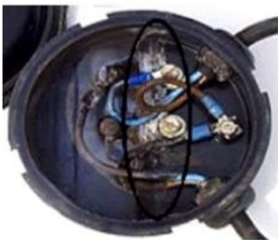
شکل (۹): خوردگی پنل‌های خورشیدی در جعبه اتصالات.
