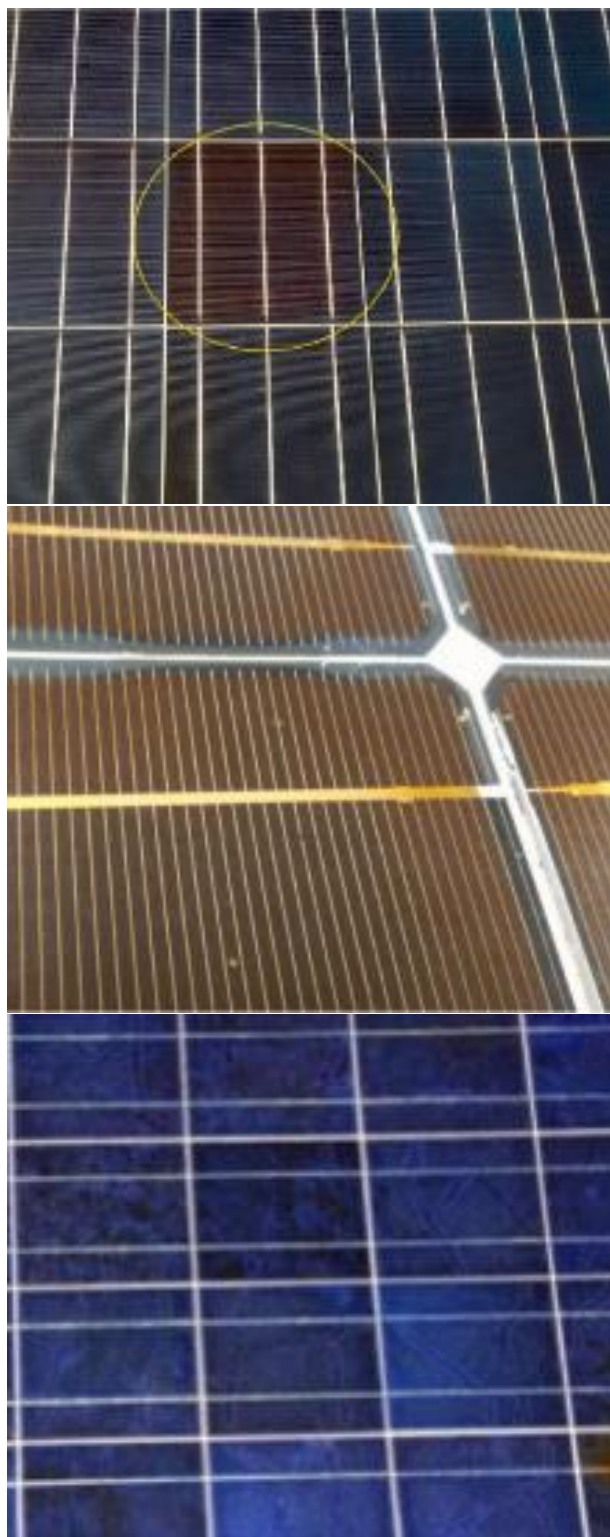
شکل (۶): اثر حلزونی روی سطح پنل های خورشیدی.
